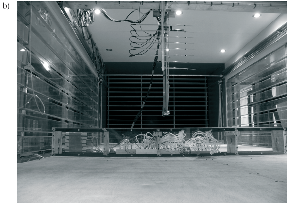
Rys. 1. Ustawienie modelu w tunelu na przykładzie modelu o wymiarach a \times a : a) schemat modelu; b) ustawienie modelu w tunelu.
