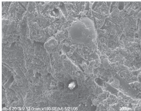
Rys. 3. Tekstura opoki wapińskiej ( K2 ) w obrazie mikroskopii elektronowej (SEM).
