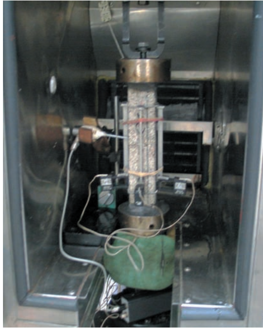
Fot. 1. Próbkę z mieszanki MCE o wymiarach 50x50x300 mm z zamocowanym czujnikiem pomiarowym analizatora EA 100 w komorze klimatyzacyjnej.
