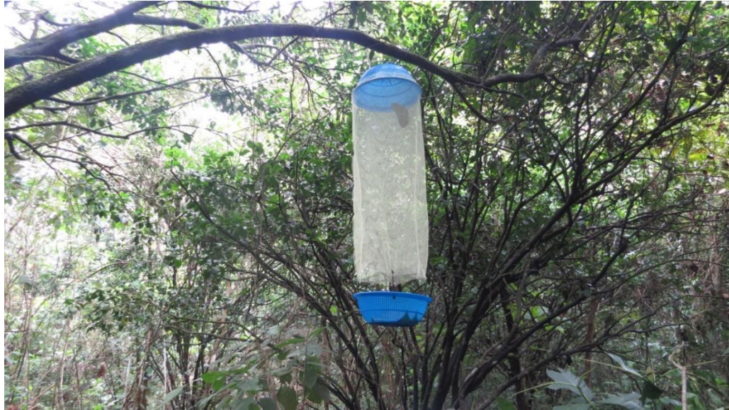
Figura 2. Trampa tipo Van Someren-Rydon instalada en el agroecosistema de Mamón – Chino (CeTAF, 2019).
