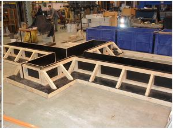
(d) Specimen formwork
