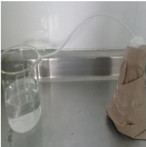
Fermentación con sistema de desfogue.
