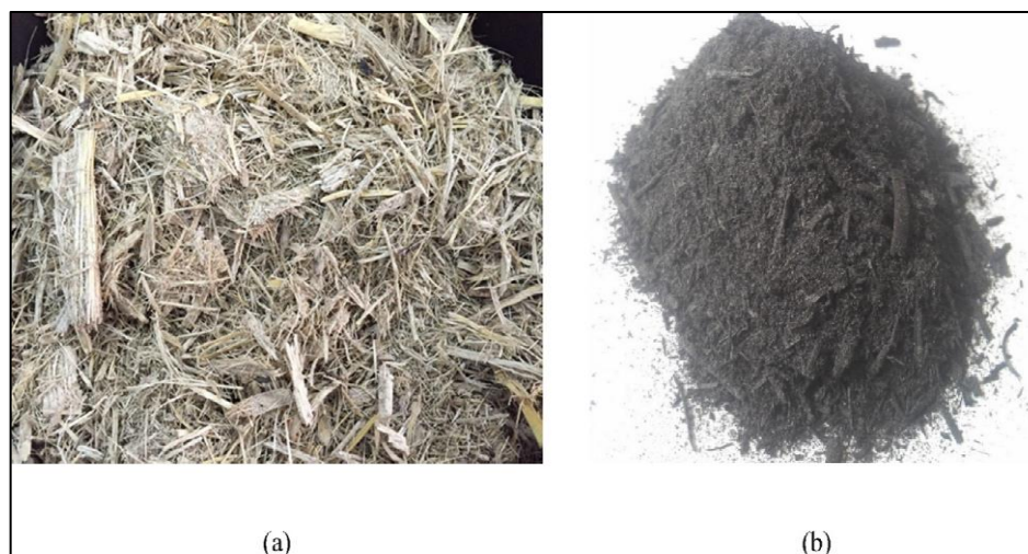
Figura 3. (a) Bagazo de Caña de azúcar, (b) Ceniza de bagazo de caña de azúcar Tomada de: (Alireza Zareei, Ameri, & Bahrami, 2018)
