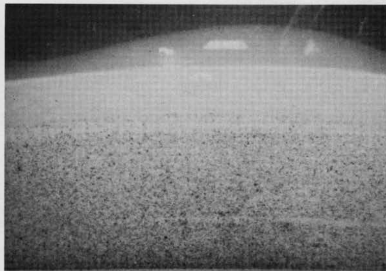
Fig. 3. — Absence de lamination à 4,7 m de profondeur, débit 400 \text{cm}^3/\text{h} . Fig. 3. — No lamination under 4.7 m, discharge 400 \text{cm}^3/\text{h} .
