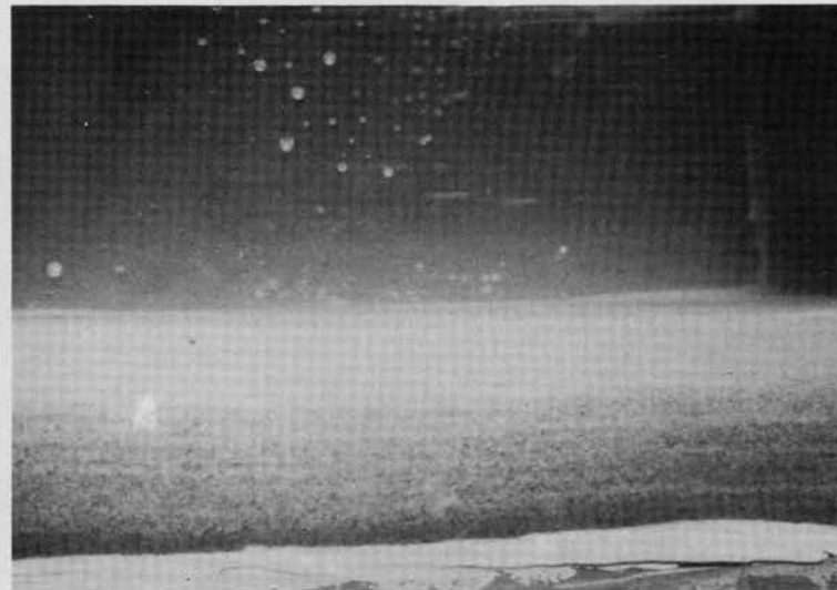
Fig. 2. — Laminations à 4,7 m de profondeur, débit 40 \text{cm}^3/\text{mm} . Fig. 2. — Laminations under 4.7 m of water, discharge 40 \text{cm}^3/\text{mm} .
