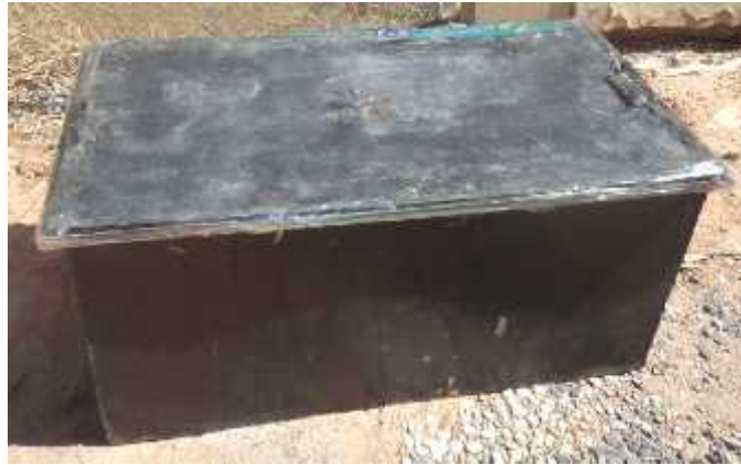
Fig. 2. 14: Enceinte métallique pour l'étuvage naturel des BTC, selon la procédure de Benammar et al. (Benammar, 2013).
