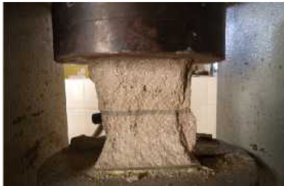
Fig.2.16 : Le bloc après écrasement
