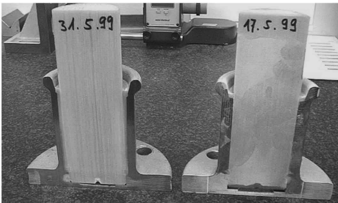
Abb. 3-15 Keine Risse, „Prüfung bestanden“: links ohne, rechts mit Farbmittel
