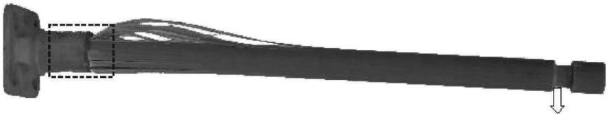
Abb. 3-35 Schadensbild eines 51 mm Isolators [Prenleoup 2008]
