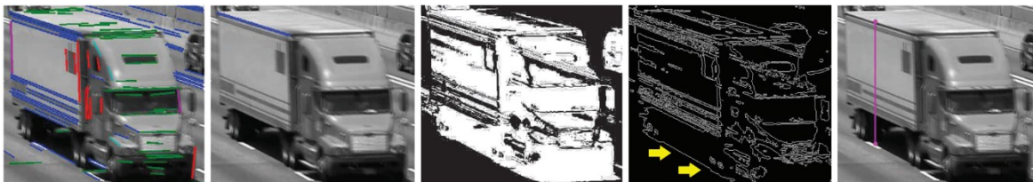
Abbildung 1-6 Höhenbestimmung nach [15] v.l.n.r.: Linienerkennung innerhalb einer Bounding Box, Auswahl der in Fahrtrichtung liegenden Linie mit kürzestem Abstand zur linken oberen Ecke der Bounding Box, Blob Detektion, Canny Edge Filter und Auswahl der untersten Linie, Abstandsberechnung zwischen oberer und unterer Linie
