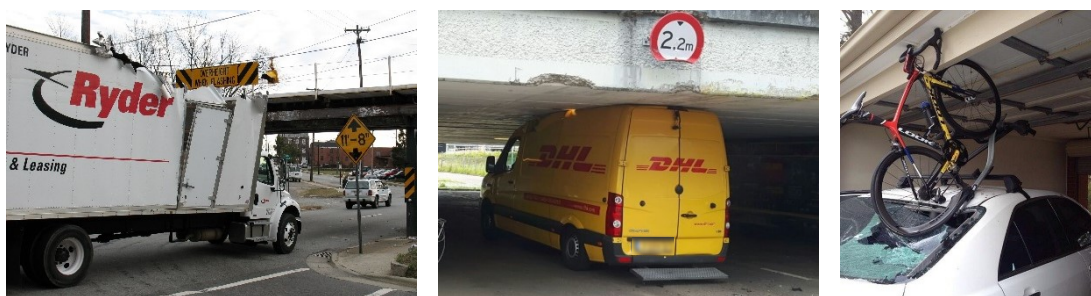
Abbildung 1-1 Beispiele für Kollisionen durch unzureichende Durchfahrthöhe [3, 4, 5]
