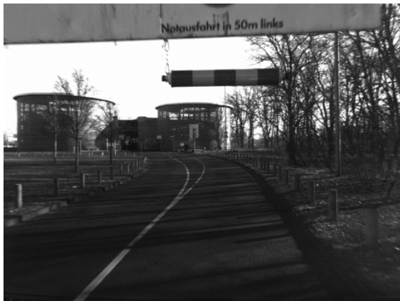
Abbildung 8-18 Zweifache Zufahrt auf eine freihängende Warnbake mit einer Höhe von 2.216 m. Zunächst erfolgt die Erkennung der größeren Schildunterkante. Bei Zufahrt auf das Hindernis schwankt die Höhe zwischen der Ober- und Unterkante der Warnbake. Die Hindernisdetektion mittels Linien schlägt fehl.
