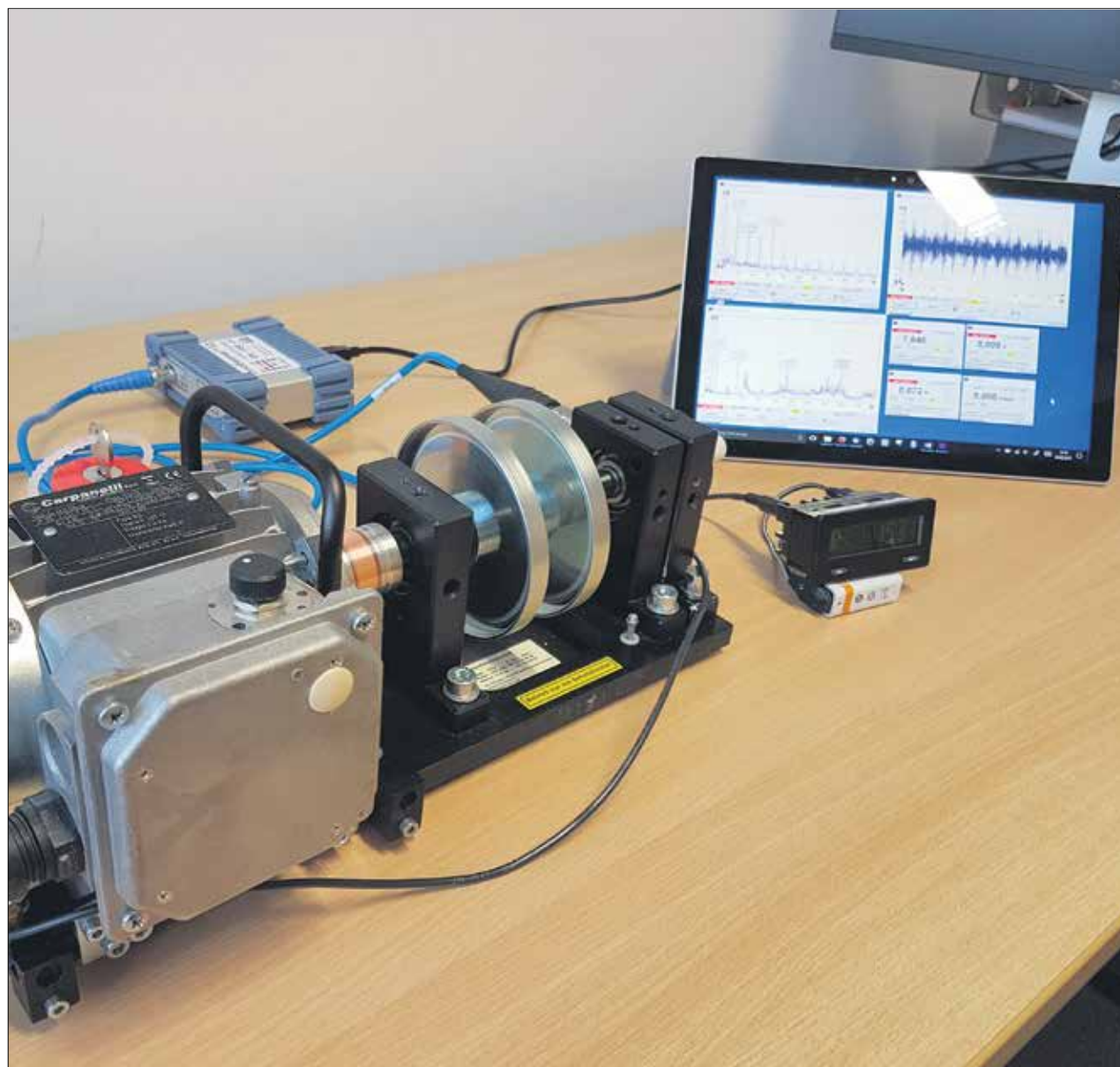
Conimon-Diagnose-Set zur Maschinen- und Anlagenüberwachung.
