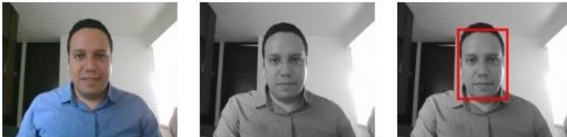
Figura 1. Proceso de detección de rostro a partir de imagen en escala de grises proveniente de una imagen RGB. Fuente: elaboración propia.
