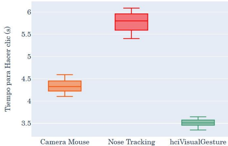
Figura 14. Tiempo para hacer clic: comparación de dos sistemas reportados en la literatura (Camera Mouse [11] y Nose Tracking [12]) y la propuesta de este trabajo denominada hciVisualGesture. Las pruebas fueron realizadas en un PC con Intel Core i7 2.5 GHz y 16 GB RAM. Fuente: elaboración propia.
