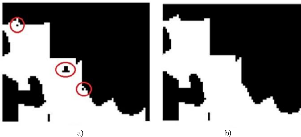
Figura 5. a) Sección de la grieta posterior a la transformada de Beamlet y b) sección después de relleno de espacios vacíos. Fuente: elaboración propia.
