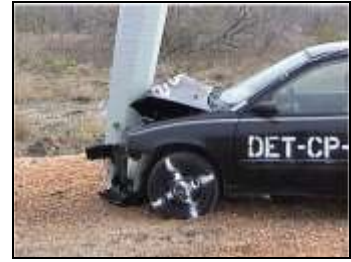
Gambar 5. Tiang utilitas dan mobil mengalami kerusakan
