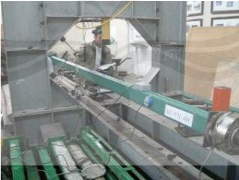
Pengujian Kolom Baja Profil C Gabungan dengan Variasi Jarak Las 4H (KCVJL-4H)
