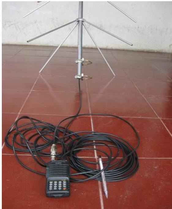
Gambar 13. Foto instrumen modul radio komunikasi data transmiter
