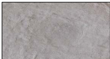
4a) List načinjen od vlakanca nakon flotacije-otok Sheet made from fibers after the flotation
