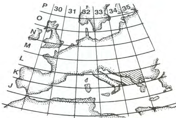
Слика бр. 8 Шема за поделба на картата со размер 1:1 000 000 на листови со димензии 6^{\circ} \times 4^{\circ}
