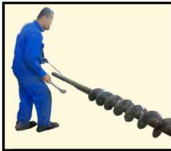
Gambar 2.32 Penarikan Blade Yang Telah Dijoin
