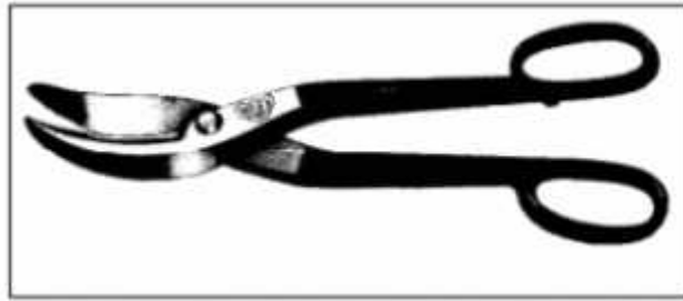
Gambar 2.13 Gunting Lingkaran (2012. Yusron Sugiarto, Modul Pemotongan Pelat)
