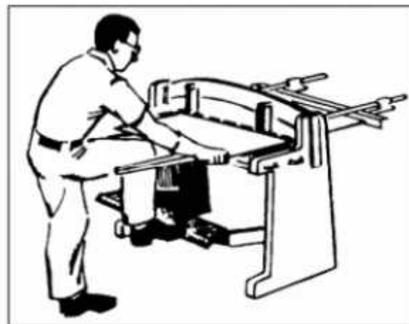
Gambar 2.23 Mesin Gullotine Manual (2012. Yusron Sugiarto, Modul Pemotongan Pelat)
