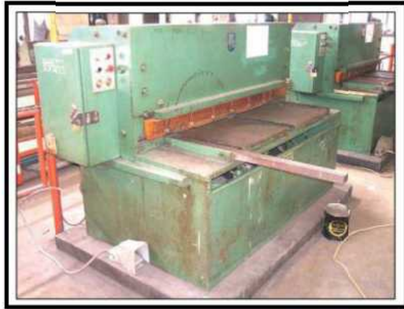
Gambar 2.3 Mesin Potong Otomatis/Mesin Guillotin Otomatis (2012. Yusron Sugiarto, Modul Pemotongan Pelat )
