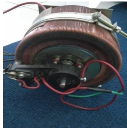
Gambar 3.11 Bentuk fisik Autotrafo
