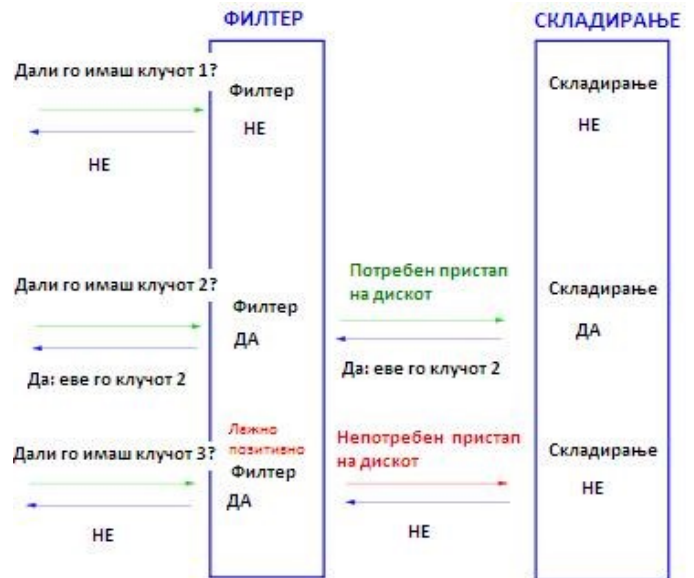
Слика 6: Приказ на работата на bloom филтерот
