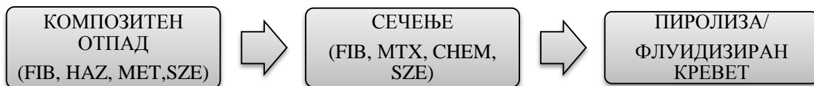
Слика 10.16.12. Шематски приказ за рециклирање на материјалите со примена на пиролиза и флуидизирана подлога
