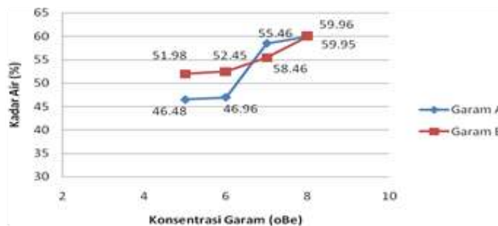
Gambar 2. Pengaruh konsentrasi garam A dan B terhadap kadar air (%) kulit pikel sapi
