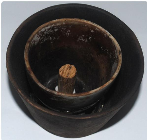
Рис. 2. Расположение древесной частицы в тигле
