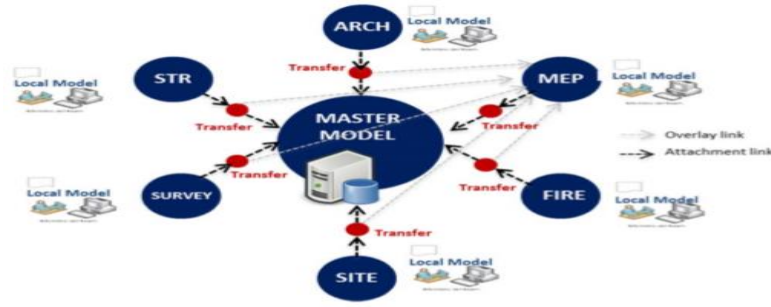
الشكل (4) يوضح النموذج المركزي لخزن المعلومات من الاختصاصات المختلفة [28,pp.55-56]
