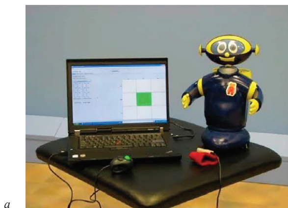
Рис. 1. Система InMotion 2 (коммерческая версия MIT MANUS) [26]
