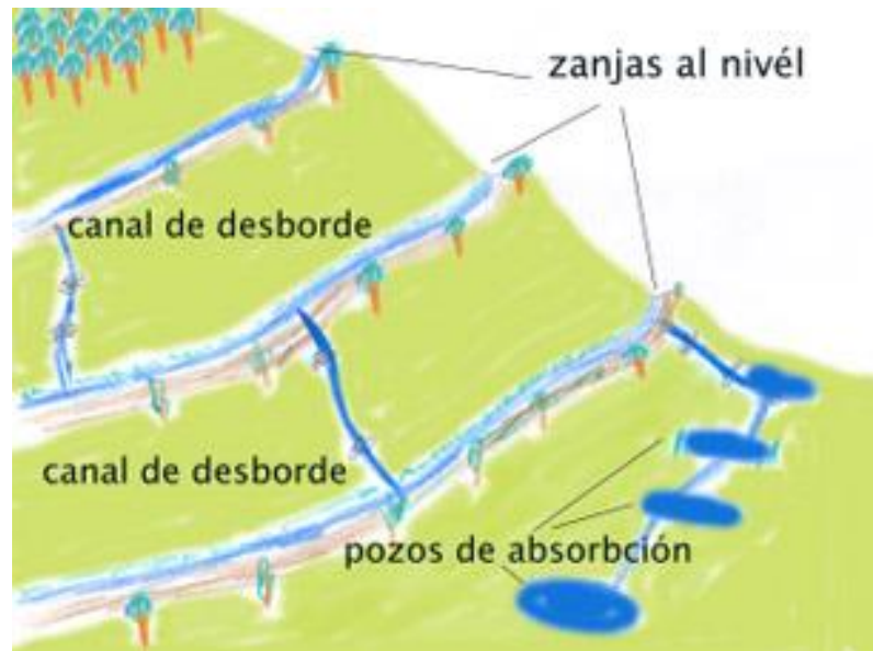
Figura 25. Zanja de infiltración
