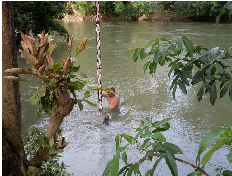
Figura 5. Medición de nivel de agua en estación hidrométrica
