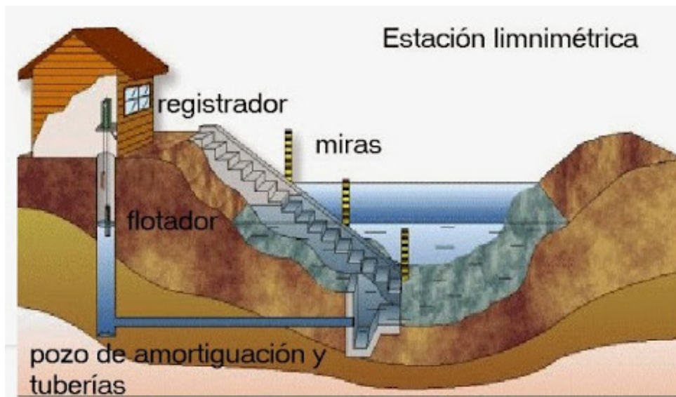
Figura 7. Esquema de estación limnimétrica
