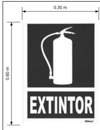
Figura 26. Dimensiones de la señal para extintores
