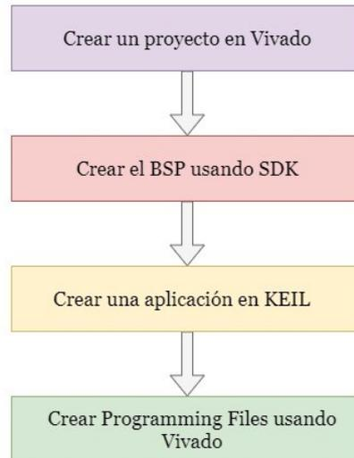
Figura 47. Diagrama de flujos para realizar la implementación.
