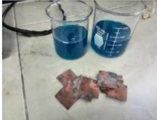
Imagen IV. Lámina de acero luego de realizar la prueba ASTM 239-89
