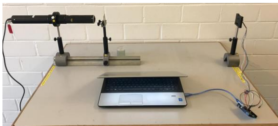
Abb.7: Aufbau Interferenz am Gitter
