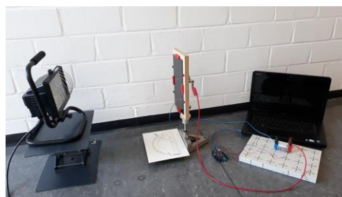
Abb.8: Aufbau Vertiefungsexperiment Photovoltaik
