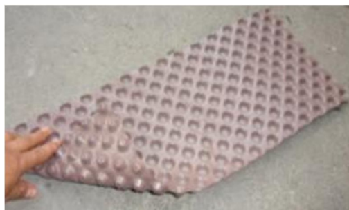
Figura 10. Forma de un manto drenante
