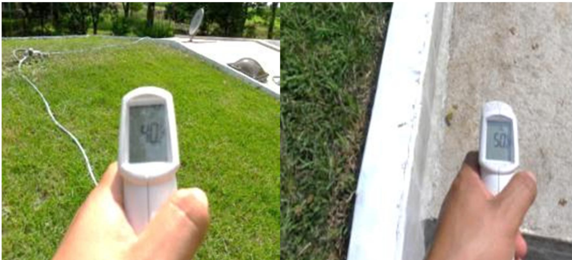
Figura 61. Registro de variación de temperatura en la instalación realizada, durante la décimo octava semana
