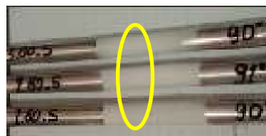
Gambar 7. Hasil Pengujian Liquid Penetrant Test Dengan Variasi Waktu 80 Detik (Sumber: Dokumentasi)
