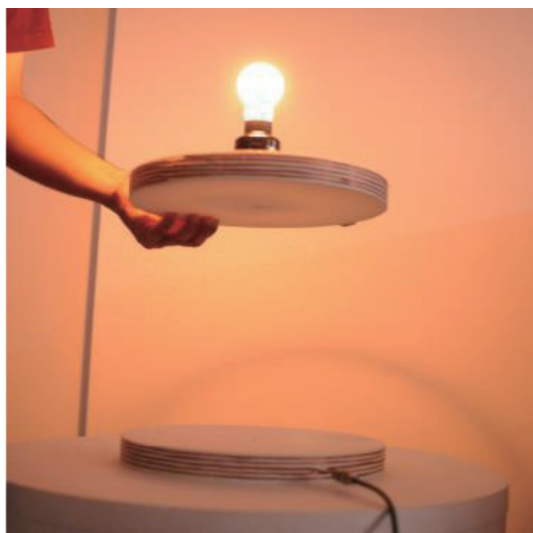
写真1 共振を用いた電磁誘導 (磁界共鳴) による電球点灯実験
