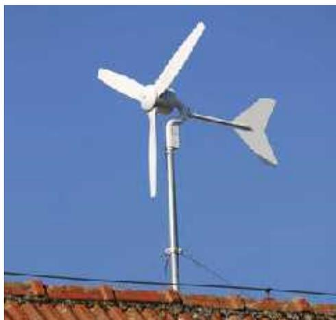
Abbildung 6: Kleinwindkraftanlage
