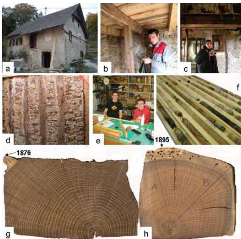
Slika 1. Matičkova domačija: (a) hiša pred prenovo, (b,c) lesene konstrukcije, (d) predelna stena, (e) študenta pri pripravi vzorcev za analize, (f) nalepljeni izvrtki pred brušenjem, (g) obdelana odrezka hrasta z jedrovino in beljavo in datumom nastanka zadnje branike.
