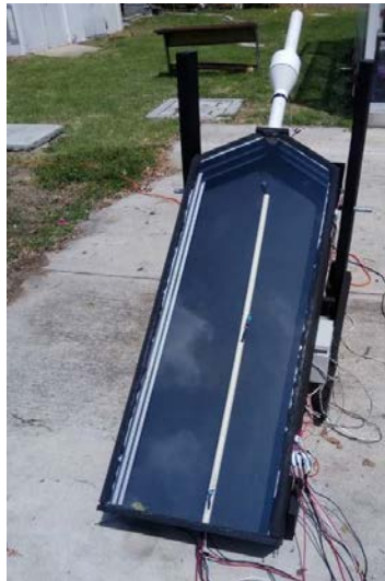
Figura 1 Colector solar para pruebas experimentales.
