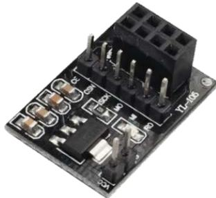
Figura 7 Módulo adaptador 1000 kbps.
