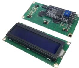
Figura 5 Liquid cristal display 16x2 con módulo I2c.
