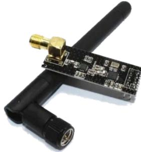
Figura 6 Módulo transceptor nrf24l01.
