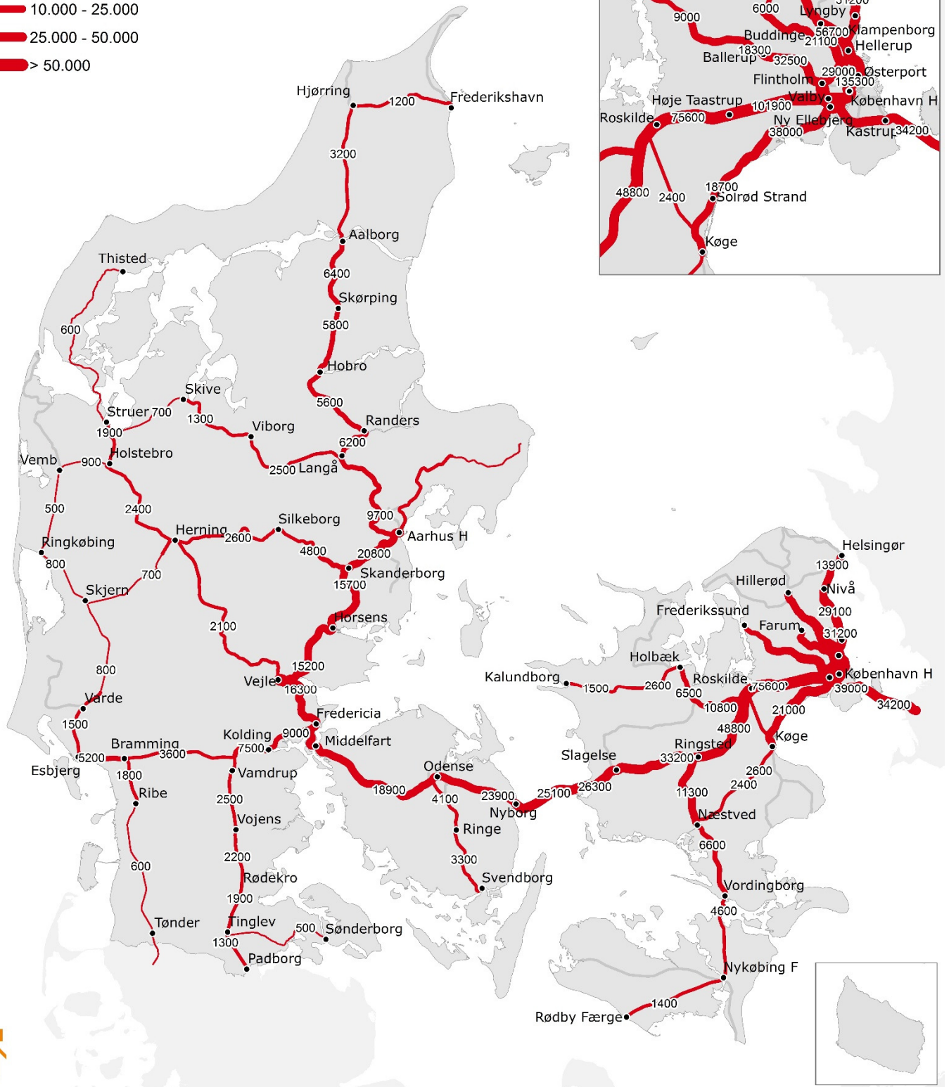
Figur 3 – Eksempel på hverdagsdøgntrafik efter genberegning i LTM.
