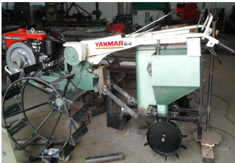
Gambar 6. Hasil Perakitan prototipe implemen penanam kentang
