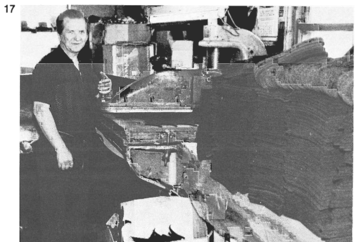
17 Machine à découper des semelles de feutre actionnée par Lionel Thibault, 32 ans de métier. [Photo: Roland Morin].
