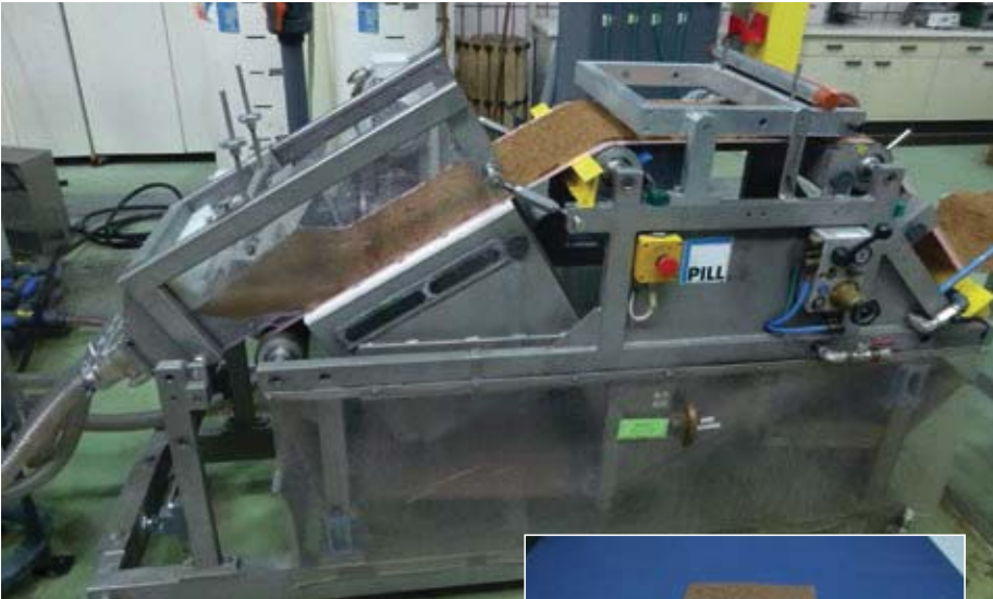
Abb. 2a: Maschine zur Erzeugung von Neptunvlies aus Posidonia oceanica
