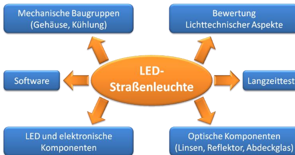
Abbildung 1.2: Problemfelder bei der Entwicklung einer LED-Leuchte
