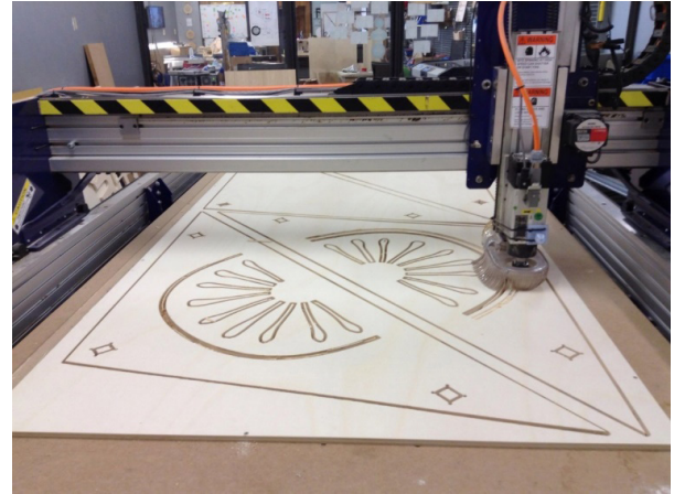
Figura 10. Fresadora CNC cortando las piezas. Fuente: Imagen propia.
