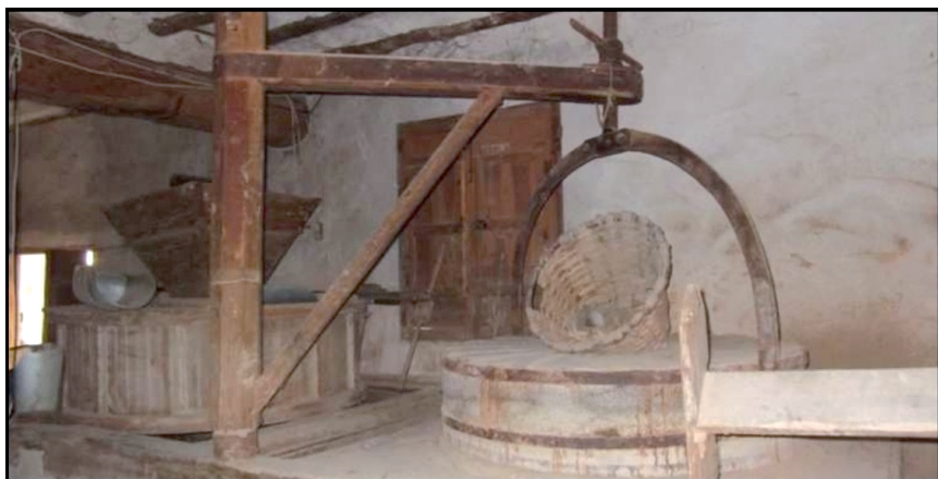
Imagen 6. Muelas del molino de Arrinda. (Fotografías del autor, 10-12-2017).
