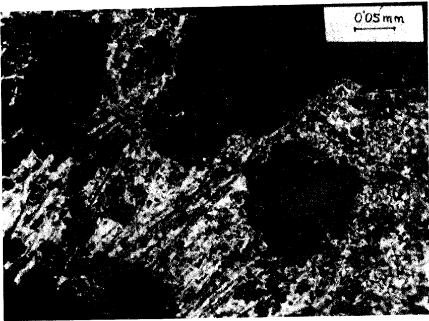
Figura 3. Formulación de wusita nucleado alrededor de un afloramiento de silicatos. Frontera de magnetita (cambio de color).
