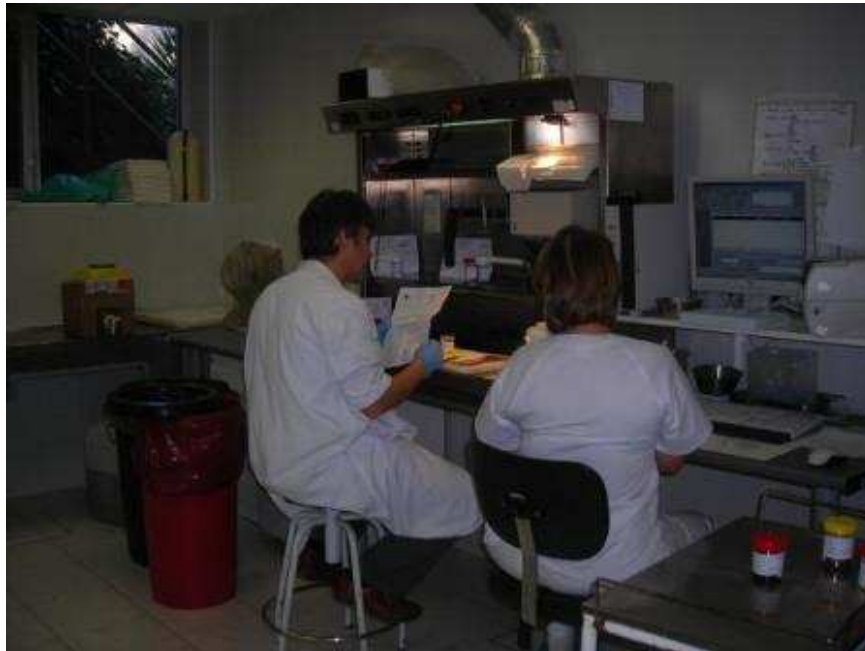
Fig 2. Sala de “tallado” del laboratorio de Anatomía Patológica. La cabina de metal cuenta con una cámara extractora de aire en la parte superior para extraer el exceso de formol en el aire. La técnico en Anatomía Patológica asiste al Médico Patólogo en el tallado de piezas.
