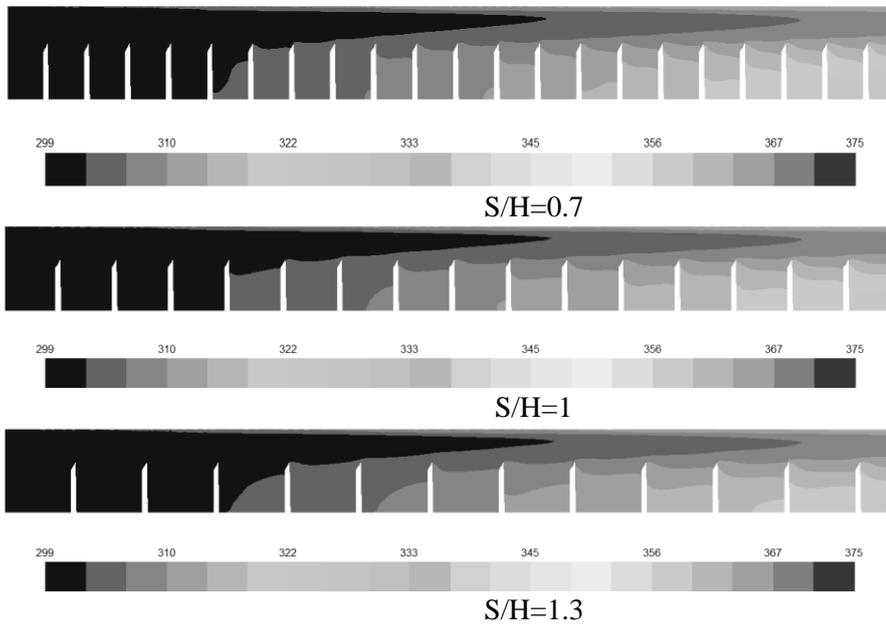
Gambar 3 Distribusi temperatur di center plane  $x=0$
